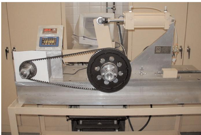
Banc d'essai pour la simulation dynamique des entraînements motos
