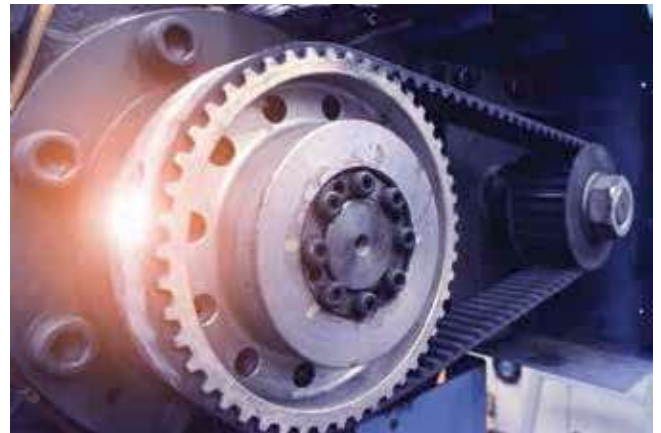
Frette SIT-LOCK® 5A avec une poulie dentée.
