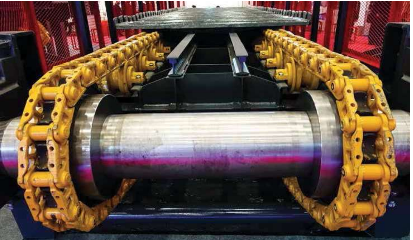
Assemblage des chaînes du convoyeur grâce à la frette SIT-LOCK® 4 COMPACT.
