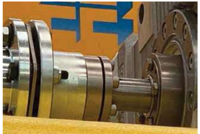
Frette SIT-LOCK® 3 avec un accouplement à disque.
